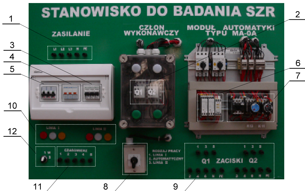
Rys. 2. Stanowisko do badania SZR: 1 – Zaciski zasilania; 2 – Styczniki Q1, Q2; 3 – Linia II rezerwowa; 4 – Lampki sygnalizacyjne; 5 – Linia I podstawowa; 6 – Układ logiczny; 7 – Przekładniki czasowe K11 i K12; 8 – Przełącznik rodzaju pracy; 9 – Zaciski styczników Q1 i Q2; 10 – Lampki sygnalizacyjne linii I i II; 11 – Zaciski czasomierza; 12 - Przełącznik W
