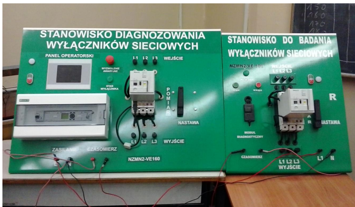
Rys. 5. Tablica z wyłącznikiem NZMN2-VE160 (po lewo), oraz tablica z wyłącznikiem NZMN2-VE100 (po prawo)
