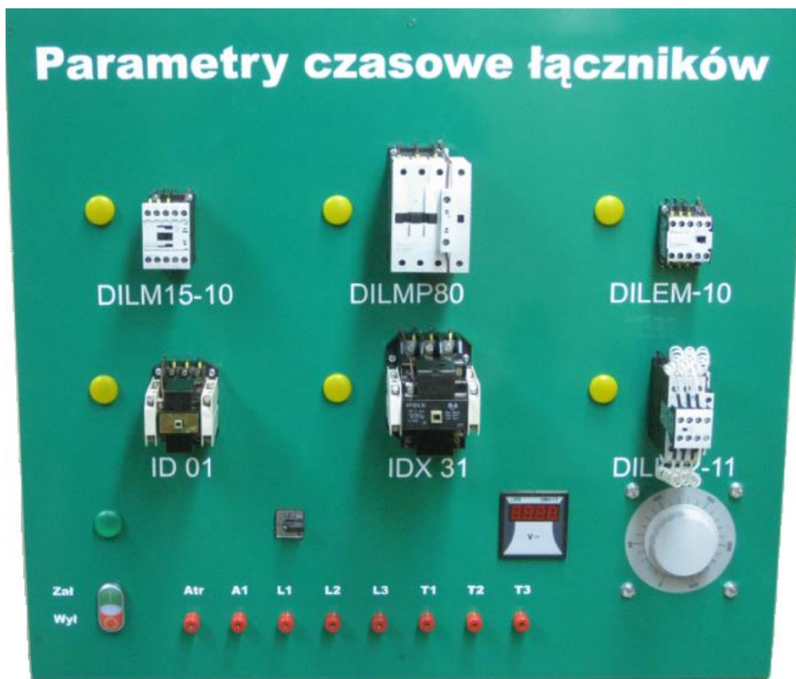
Rys. 7.1. Płyta czołowa panela sterowniczego
